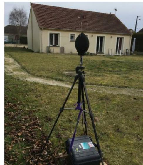
Exemple d'un sonomètre
