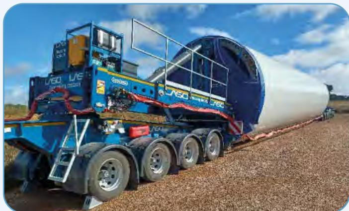
*Convoi de transport d'une section de mât (~25m).*
