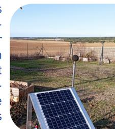
Des normes précises doivent être respectées quant à la qualité des micros et leur position pour cette mesure spécifique, ainsi que lors de l'analyse des mesures. La réglementation portant sur les niveaux de bruits à l'extérieur des habitations, tous les micros sont placés en dehors des maisons (jardins, terrasses...).
