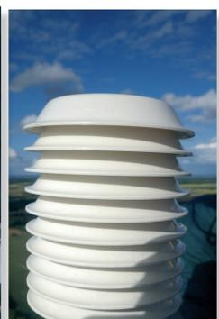
**Sonde de température :** transforme l'effet du réchauffement ou du refroidissement en signal électrique.
