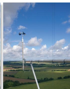
**Anémomètre :** Appareil permettant de mesurer la vitesse ou la pression du vent.
