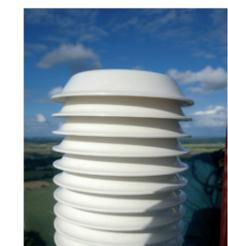
Sonde de température Transforme l'effet du réchauffement ou du refroidissement en signal
