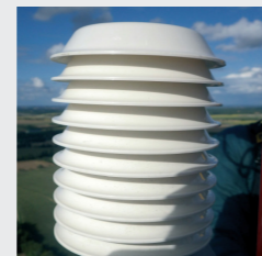
Sonde de température Transforme l'effet du réchauffement ou du refroidissement en signal électrique
