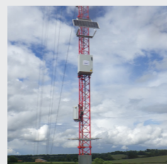
Coffret data logger Enregistre et transmet les données mesurées
