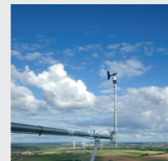
Girouette Mesure les directions du vent
