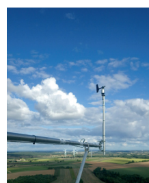
Girouette Mesure les directions du vent
