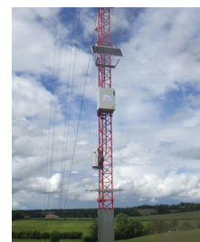
Coffret data logger Enregistre et transmet les données mesurées
