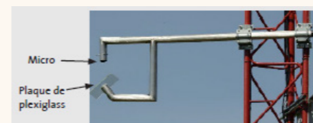
Exemple de batcorder utilisé pour identifier les chiroptères, sur mât de mesure. Source : ENCIS Environnement.
