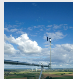
Girouette Mesure les directions du vent
