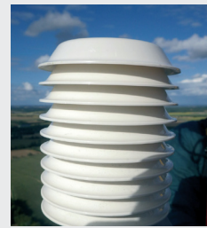
Sonde de température Transforme l'effet du réchauffement ou du refroidissement en signal électrique
