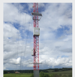
Coffret data logger Enregistre et transmet les données mesurées
