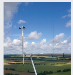
Anémomètre Mesure la vitesse et la pression du vent
