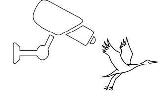
La vidéo détection: il s'agit d'un système de détection des oiseaux avec programmation d'arrêt de la machine lorsque cet oiseau se trouve à proximité de l'éolienne. L'éolienne redémarre uniquement lorsque l'oiseau quitte la sphère de détection.
