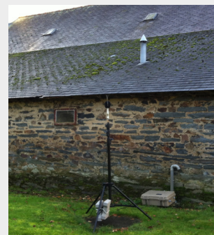
Exemple de sonomètre posé par ABO Wind sur un point d'écoute
