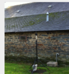
Exemple de sonomètre posé par ABO Wind sur un point d'écoute
