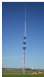
Mât de mesure du projet éolien des Plans, sur la Faye et Villegats
