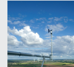
Girouette Mesure les directions du vent
