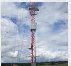
Coffret data logger Enregistre et transmet les données mesurées
