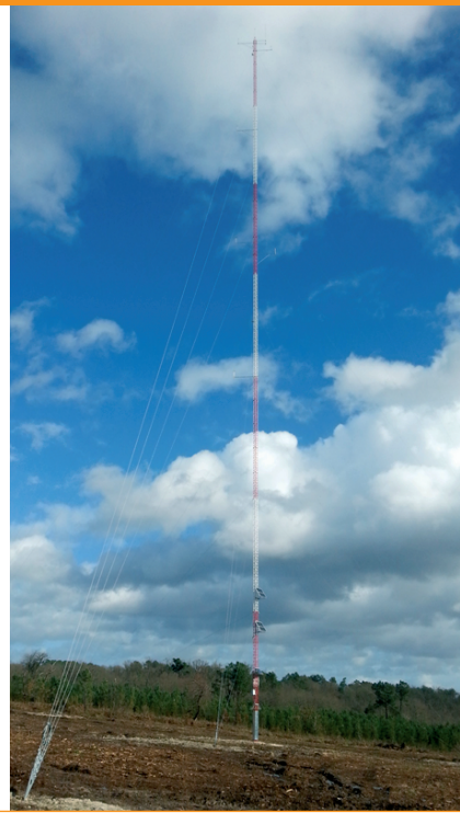
Mât de mesure de 100 m sur une zone d'étude
