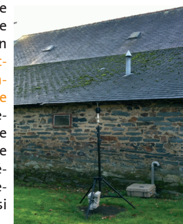
Exemple de sonomètre posé par ABO Wind sur un point d'écoute
