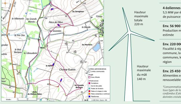
5,5 MW par éolienne soit 22 MW de puissance totale
