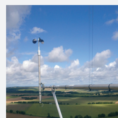
Anémomètre Mesure la vitesse et la pression du vent
