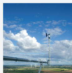
Girouette Mesure les directions du vent
