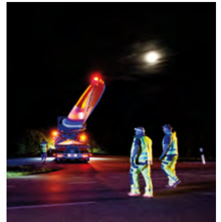
Der Transport der Großkomponenten, wie hier der Rotorblätter, darf nur nachts erfolgen.
