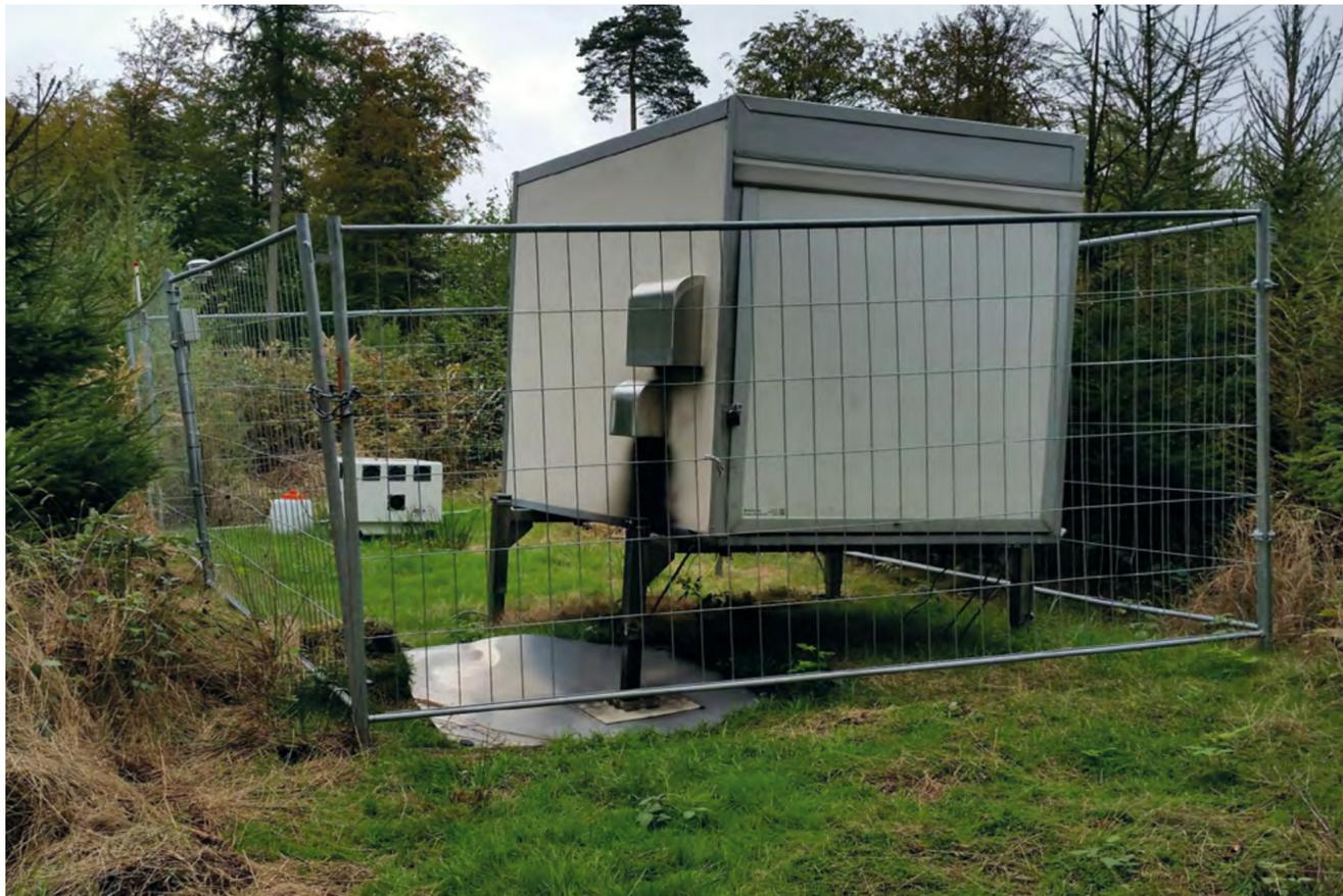
*LiDAR-Messgerät – Fotos aus einem anderen hessischen Projekt (Nentershausen)*
